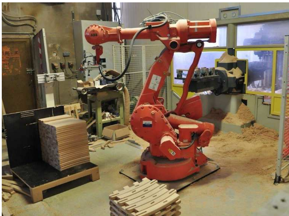
Les procédés ont été automatisés à l'instar de ce robot à commande numérique dédié au chargement/déchargement et au contrôle qualité. © Philippe Bohlinger.
